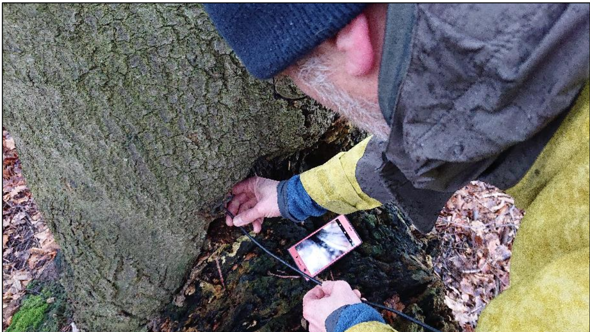
Abbildung 5: Beispielhaft: Endoskop im Einsatz
