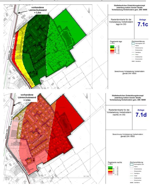
Als aktiven Lärmschutz bezeichnet man Maßnahmen in unmittelbarer Nähe der Lärmquelle (Emissionsort). Sofern die Orientierungswerte für die Nutzung überschritten werden, ist zu überlegen, welche Lärmschutzmaßnahmen in Frage kommen. An erster Stelle sollten aktive Lärmschutzmaßnahmen stehen, da hier ein größeres Lärmminderungspotential auszuschöpfen ist. An Möglichkeiten gibt es: Lärmschutzwand oder - wall.
